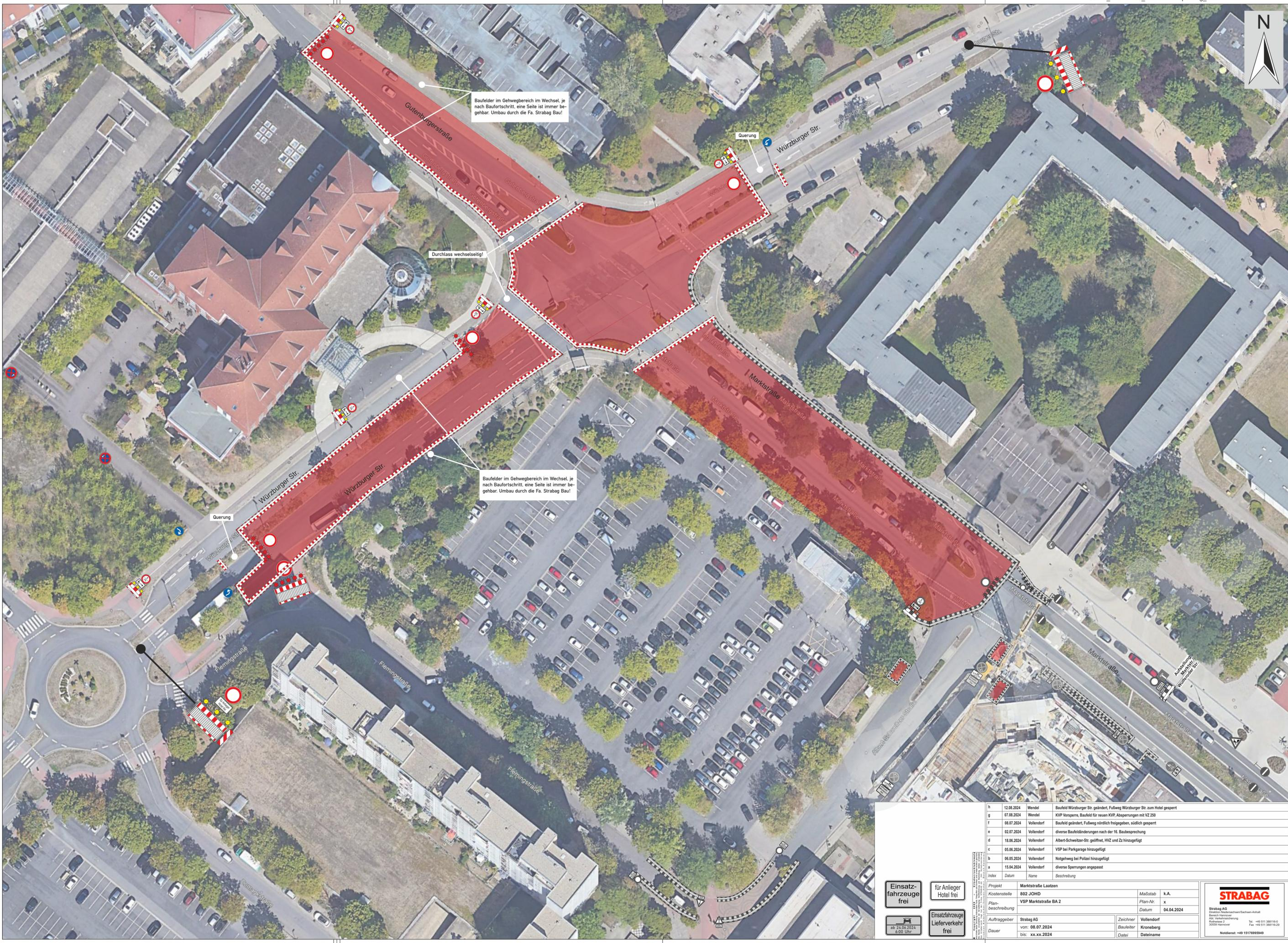
Baufelder im Gehwegbereich im Wechsel, je nach Baufortschritt, eine Seite ist immer begehbar. Umbau durch die Fa. Strabag Bau!
